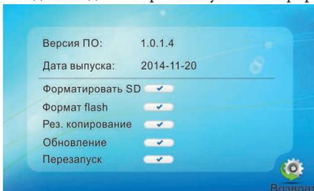
Здесь отображается текущая версия ПО и дата его выпуска. Также здесь выполняется обновление прошивки и перезапуск монитора, а также форматирование внутренней флеш-памяти или внешней карты памяти. Команда «Рез. копирование» позволяет перенести фотографии из внутренней памяти на карту micro-SD. Некоторые функции могут отсутствовать - в этом случае следует обновить версию ПО до последней актуальной версии.
