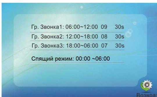
Здесь можно настроить громкость и длительность звонка для трёх различных периодов времени, выбранных пользователем, а также задать расписание работы «Спящего режима», активацию которого можно произвести в разделе меню «Режим». Во время «спящего» режима, монитор не реагирует на сигналы вызова.
