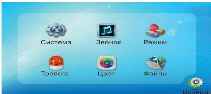
Для навигации по разделам меню используется прокрутка кнопки-колесика, а для входа в нужный раздел следует нажать на неё. Находясь в выбранном разделе, выбор нужного параметра осуществляется нажатием на кнопку-колесико, а регулировка значений - прокруткой.
